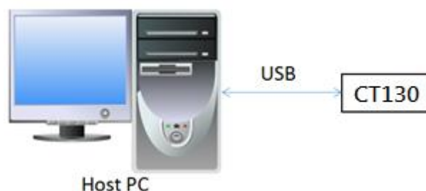
圖 10-1 通過 USB 孔將 CT130 板連接到主機 PC
